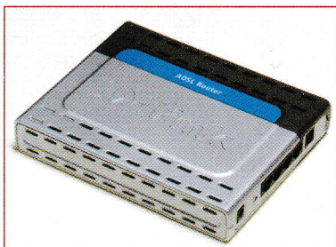
Un encaminador o router.
