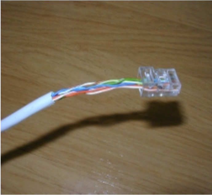
Cable mal hecho
