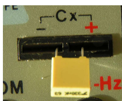
Figura 9. Detall de la connexió d'un condensador per a la mesura de la seva capacitat.
